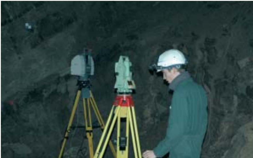
Figure 26 : Scan d'une chambre d'exploitation
